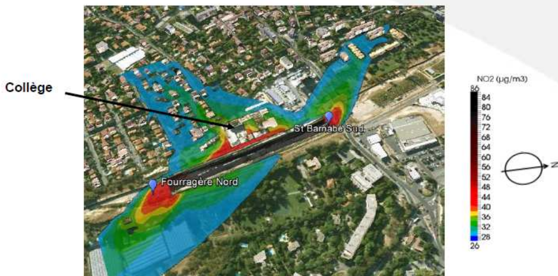
Figure 52 : Visualisation de la concentration moyenne annuelle de NO 2 entre la sortie St Barnabé (St Barnabé Sud) et l'entrée de la Fourragère (Fourragère Nord)
