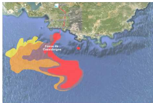
Exemple du taux de titane dans le déversement des boues rouges dans la fosse de Cassidaigne
